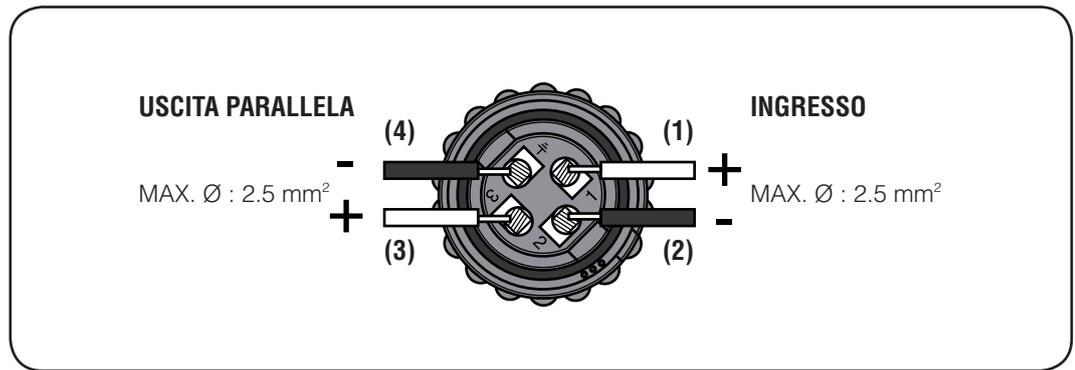
Osservando la parte posteriore del connettore (E), collegare il conduttore proveniente dall'uscita + dell'amplificatore al contatto 1 e l'altro conduttore (uscita - dell'amplificatore) al contatto 2, poi fissare il connettore (E) al guscio posteriore (A).
