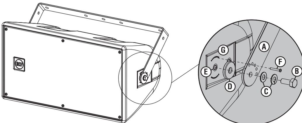
Unire il diffusore alla staffa a U **(A)** avvitando (su entrambi i lati) un bullone M8 **(B)** nel foro del diffusore **(E)** passando per le 2 rondelle **(C)** e la rondella-distanziatore **(D)**.
