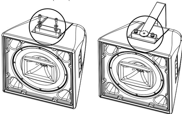
**Nota:** è possibile rimuovere una delle due coppie di bulloni laterali (usate per fissare gli spessori) nel caso sia necessaria un'angolazione orizzontale particolare.
